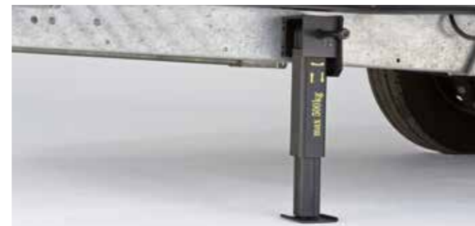
Stütze fährt automatisch teleskopartig aus
