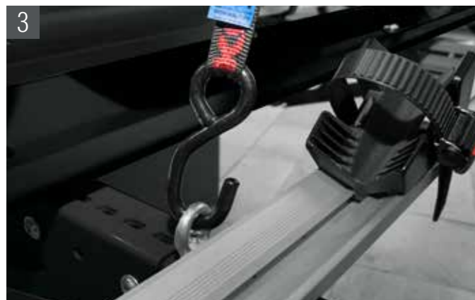
3 Zwei Zurrösen am Heckträger
