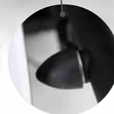
Stabiler Schutz vor Beschädigung der Hecktüren
