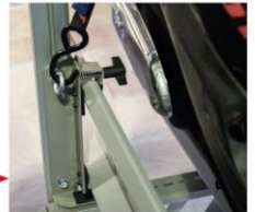
Zwei Zurrösen am Haltebügel
